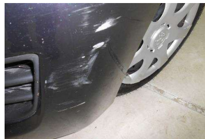
Niet acceptabel, door de lak heen
